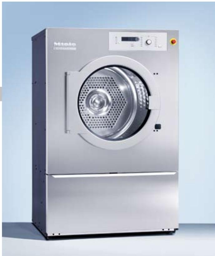
Сушильная машина с управлением Profitronic B: Посредством поворотного выключателя обеспечивается выбор времени сушки в диапазоне от 5 до 60 минут с шагом 5 минут. Для выбора доступны 4 различных значения температуры (холодный воздух, низкая, средняя и высокая температуры сушки). Благодаря наличию контрольных индикаторов «Очистить ворсовый фильтр» и «Неисправность воздуховода» обеспечивается непрерывный и безаварийный процесс сушки.
